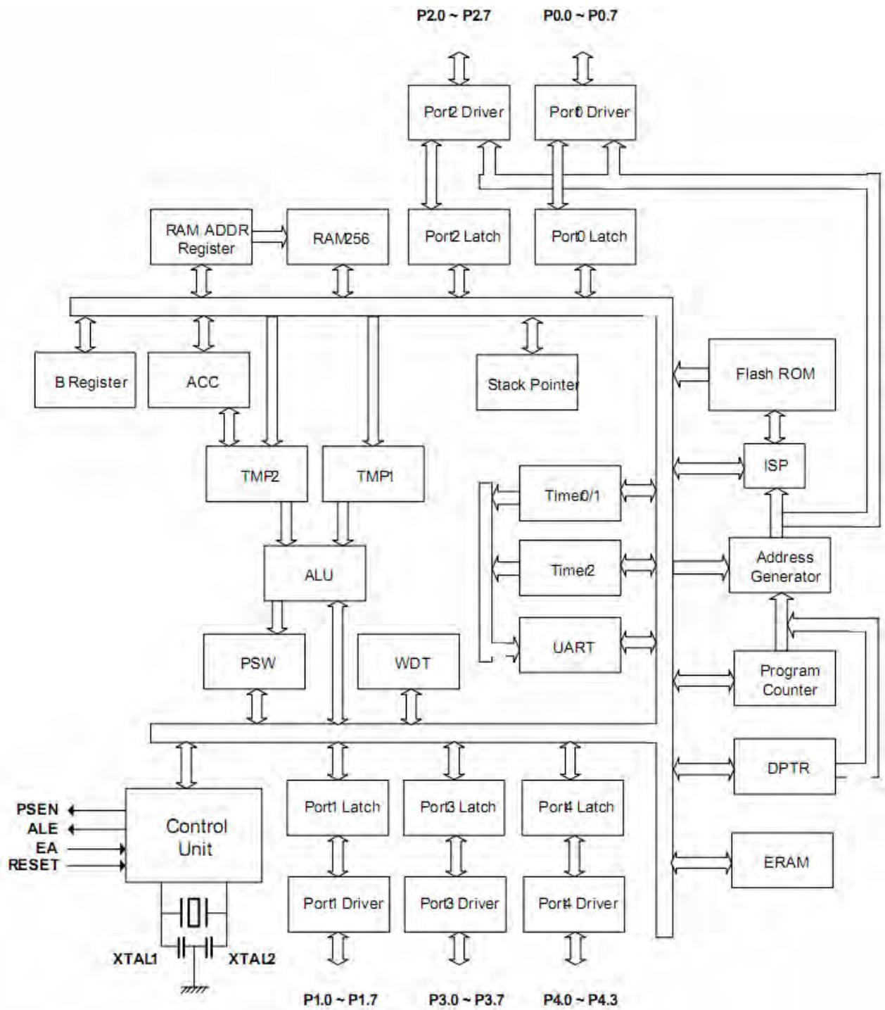
MPC89x5x 结构方框图
